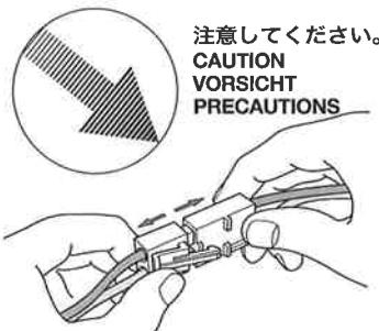
走行させない時は必ずバッテリーのコネクターを外してください。走行用バッテリーをつないだまましておくと、車が暴走することがあります。走らせないときは、必ず走行用バッテリーのコネクターを抜いておきます。
