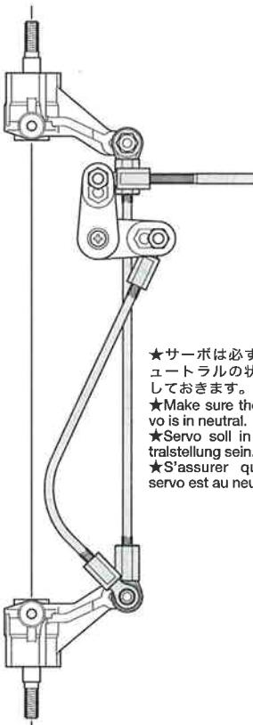
★プロポのスティックが中立のとき、アップライトが一直線になるように調節します。
