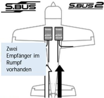
FDLS-1 ist ein Sicherheitssystem. Im Falle von Problemen mit dem Haupt-Empfänger wird automatisch auf den Sub-Empfänger umgeschaltet und der Flug sicher fortgeführt.
