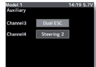
Kanalbelegung wird auf Bildschirm „Zusatz-Kan.“ angezeigt
