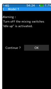
Wenn beim Einschalten des Senders die Funktion Leerlauf erhöht etc. (Gasvorwahl) aktiviert ist, ertönt ein Warnsignal mit betreffender Meldung im Display. Der Warnton und die Displayanzeige können abgeschaltet werden, wenn der betreffende Mischerschalter auf AUS betätigt wird.
