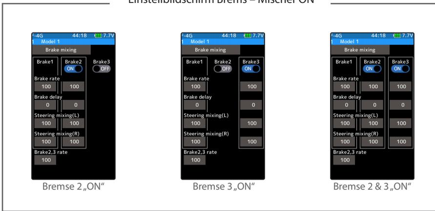
Der Brems - Mischer benötigt jeweils die Kanäle 3 und 4. Sollten Kanal 3 oder 4 bereits durch andere Mischer belegt sein, müssen Sie diese vorgängig ausschalten oder löschen.
