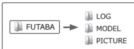
Die aufgezeichneten Telemetriedaten auf der microSD-Karte müssen zur Einsicht auf dem PC/ Laptop zuerst in eine .csv-Datei umkonvertiert werden. Dazu muss die Freeware „Telemetry data log converter“ ( siehe [www.arwico.ch](http://www.arwico.ch)-> Download-> Futaba Users ) installiert werden. Wenn eine Telemetrie - Aufzeichnung kopiert oder verschoben werden soll, müssen sowohl die .FLI- wie auch die .FLD-Files angewählt werden.
