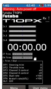
Wenn der Sender über längere Zeit nicht benutzt wurde, weder zur Steuerung noch zur Eingabe von Daten, ertönt dieser Alarm. Damit wird erreicht, dass der Akku nicht unnötig entladen wird. Nach dem Auslösen des Alarms, sollten Sie den Sender umgehend ausschalten oder einen Taster drücken.
