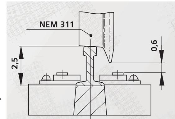
Die maßstäblichen Schienenprofile mit einer Höhe von 2,5 mm gewährleisten den Verkehr von Fahrzeugen verschiedenster Hersteller mit herkömmlichen Radsätzen.
