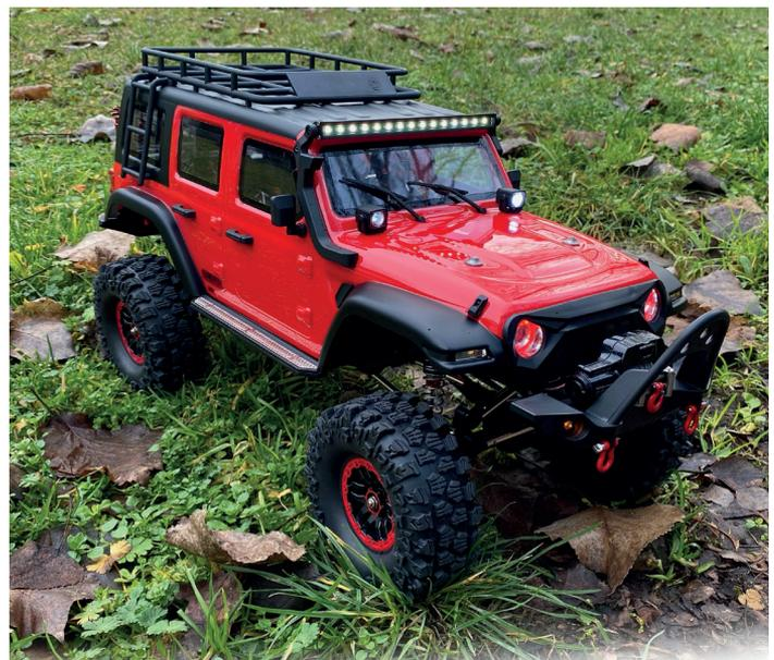
Die Differenziale des Modells sind unterschiedlich per Fernsteuerung sperr- oder entsperrbar (beide entsperrt, beide gesperrt, nur vorne gesperrt und hinten entsperrt).
