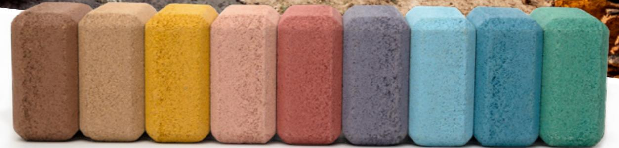
*durch die Zugabe von Harz kann unser Kork in Formen gepresst, geschliffen und gefärbt werden!*
