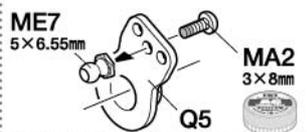
★サーボがニュートラルの状態での図のように取り付けます。
