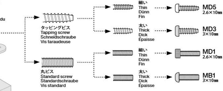
★使用するサーボの取り付け部に合わせて選びます。
