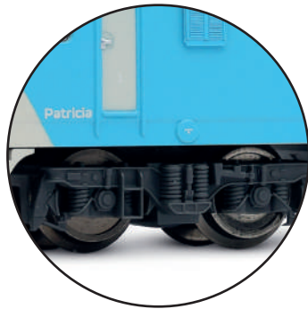
Bogies de alta velocidad aptos para 160km/h
